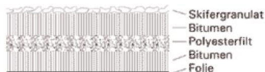
Figur 1 Opbygning af PTM BituFlex
